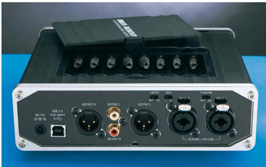
*Per essere un registratore portatile mostra una dotazione di prese completa e flessibile; si notino in particolare i connettori per il segnale d'ingresso che permettono di utilizzare connettori bilanciati XLR o, in alternativa, i jack tipo cuffia sia in modalità bilanciata (ovviamente quelli stereo) che single-ended. Le batterie sono alloggiata nel vano ricavato nella parte superiore dell'apparecchio.*
